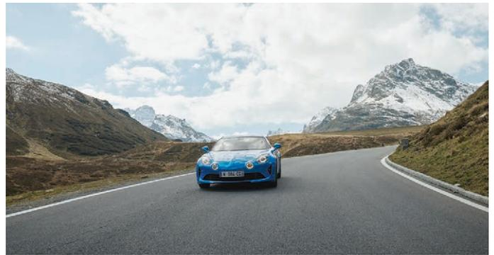
La ripartizione ottimale delle masse, con il 56% al posteriore con il motore in posizione centrale-posteriore e il 44% all'anteriore con il serbatoio del carburante posizionato dietro all'asse anteriore, esalta il piacere di guida di A110 e garantisce equilibrio e agilità eccezionali su ogni tipologia di strada.
