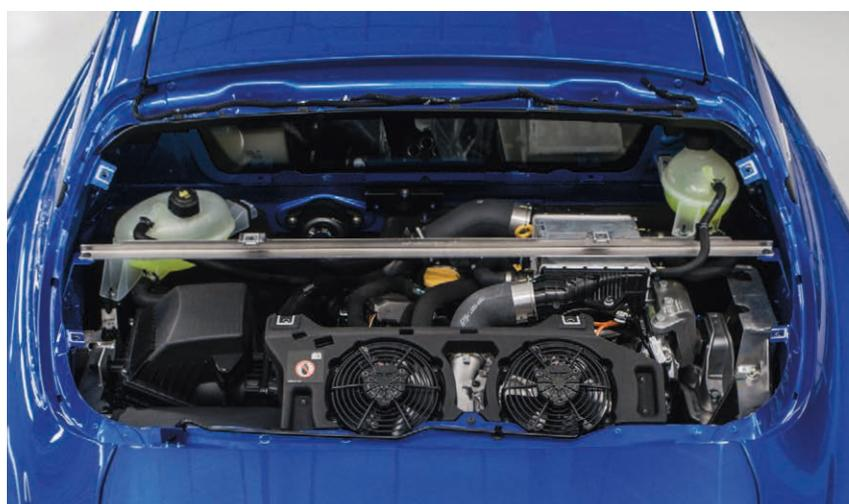
Il motore a iniezione diretta da 1,8 litri è stato progettato dagli ingegneri di Alpine per offrire il massimo del piacere di guida e delle prestazioni. I suoi 300 CV erogano una coppia generosa, disponibile da 2.400 a 6.000 giri/min, e portano la A110 R da 0 a 100 km/h in soli 3,9 secondi, con una velocità massima in circuito di ben 285 km/h.
